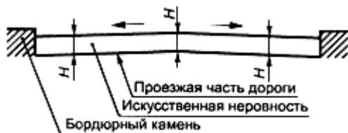
**III** - при одностороннем поперечном уклоне проезжей части и отсутствии дождеприемного колодца в нижнем лотке с верховой стороны дороги на спуске у ИН (см. рисунок 2в)
