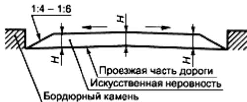
**II** - при двустороннем поперечном уклоне проезжей части и наличии дождеприемных колодцев с верховой стороны дороги на спуске у ИН
