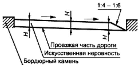
**IV** - при одностороннем поперечном уклоне проезжей части и наличии дождеприемного колодца в нижней лотке с верховой стороны дороги на спуске у ИН (см. рисунок 2г)
